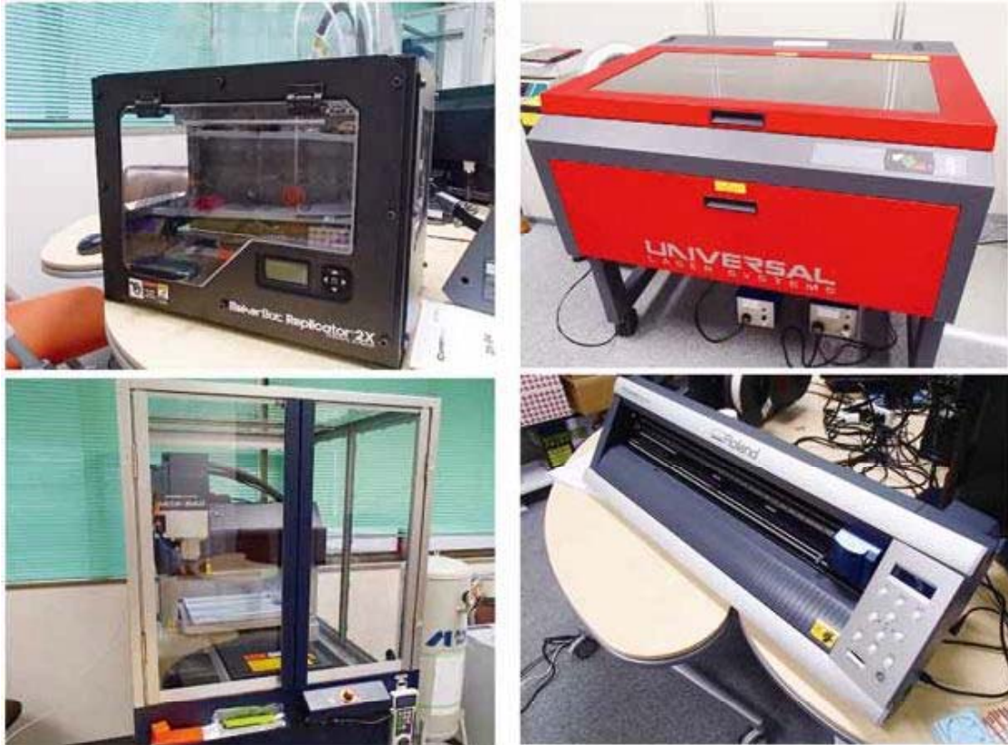
図5 (左上) 3Dプリンター (右上) レーザー加工機 (左下) CNCミリングマシン (右下) カッティングマシン
